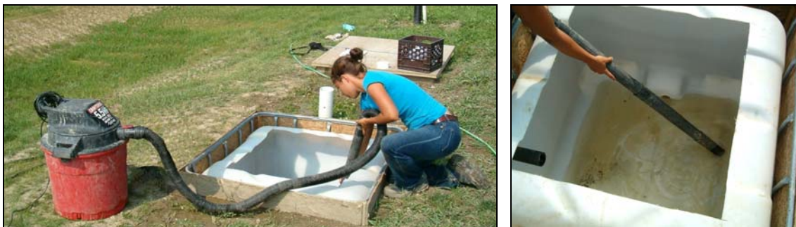
Figure 7.8 : Mesure des volumes d'eau et échantillonnage des MES
