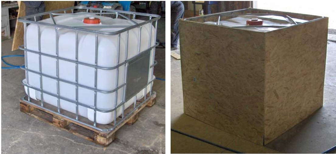
Figure M.4 : Confection des réservoirs utilisés pour la collecte des eaux de ruissellement
