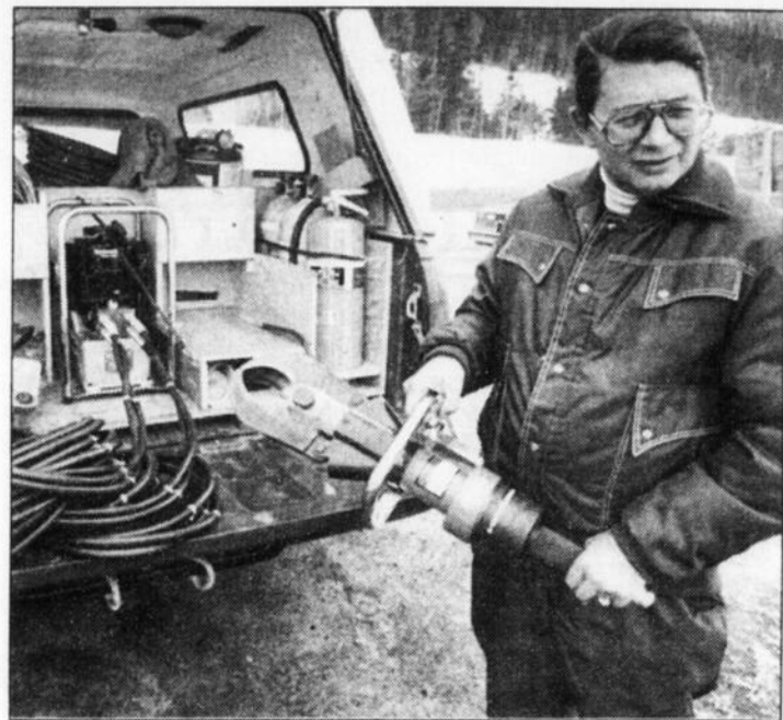
CISAILLES DE VIE - Cet équipement, que nous montre le patrouilleur Raymond Girard, communément appelé les mâchoires de vie, peut sauver la vie à des automobilistes, victimes d'accidents de la route.
