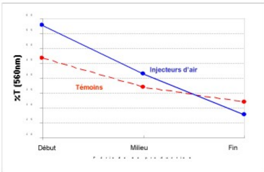
Évolution de la couleur du sirop d'érable pour des échantillons produits avec ou sans utilisation d'un système à injection d'air, au cours de la période de production
