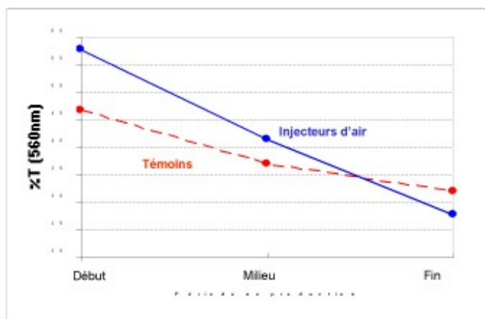
Évolution de la couleur du sirop d'érable pour des échantillons produits avec ou sans utilisation d'un système à injection d'air, au cours de la période de production
