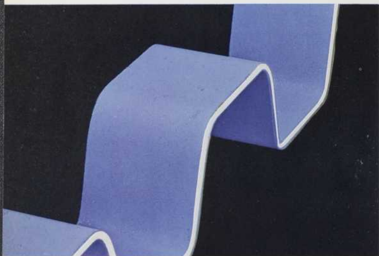
CINTRAGE Le revêtement n'est pas affecté par le cintrage normal. ▲
