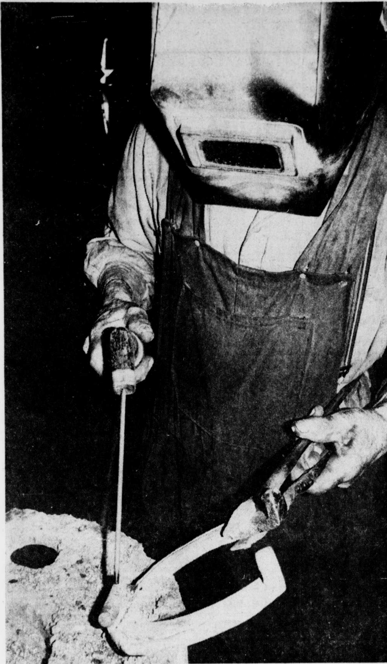
Odilon Goupil prend de l'avance sur son travail en soudant crampons et pinces sur le fer avant que son "client" n'arrive.
