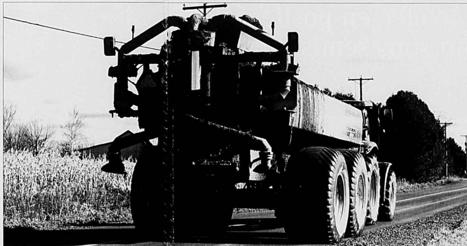
L'épandeur à lisier fait partie des machineries considérées comme des remorques. Et ce type de remorques doit avoir une largeur maximale de 3,75 mètres comprenant les roues, et 2,60 mètres sans les roues.
