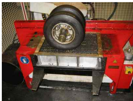
Figure 4.8 Compacteur de plaques MLPC (LUCREB ÉTS)
