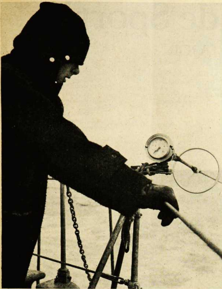
Le loch est un des nombreux instruments avec lesquels les marins de la Marine royale du Canada doivent se familiariser. Comme on le voit sur cette photo, c'est un appareil placé à la poupe du navire. Par son mécanisme cet instrument enrégistre en nœuds la distance parcourue par le vaisseau.
