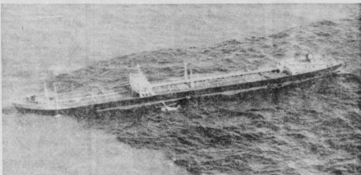
Brisé au flanc par les récifs, le "Torrey Canyon", laisse échapper le liquide visqueux qui a déjà atteint certaines plages de la côte anglaise. Dans quelques minutes, la coque se fendra en deux, puis la structure des ponts se détachera à son tour.
