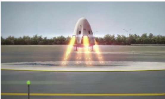
Les moteurs-fusées Draco servent, entre autre, à amortir l'atterrissage des Crew Dragon .
