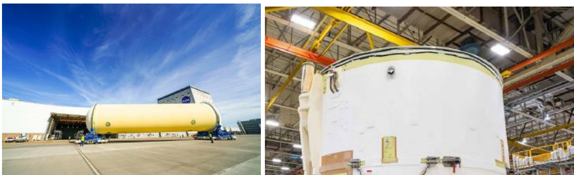
À gauche, le premier étage de la fusée SLS et, à droite, son ensemble de moteurs-fusées.
