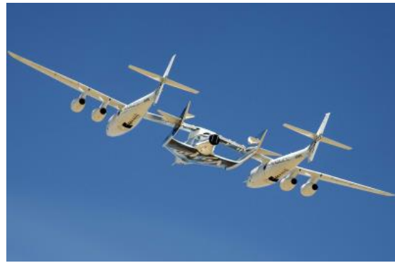
L'avion porteur du SpaceShipTwo .
