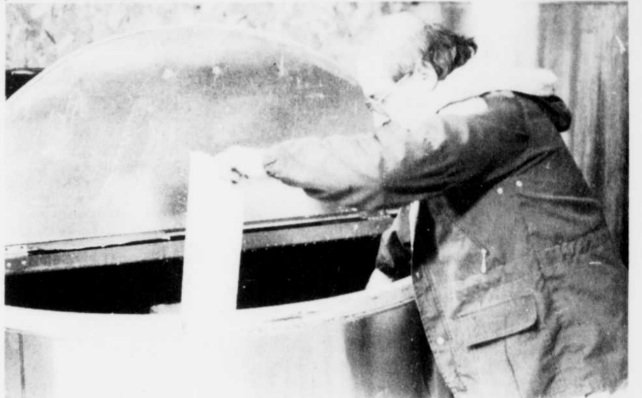
Après la déshumidification, les rayons sont déposés dans un extracteur qui siphonne le miel.
