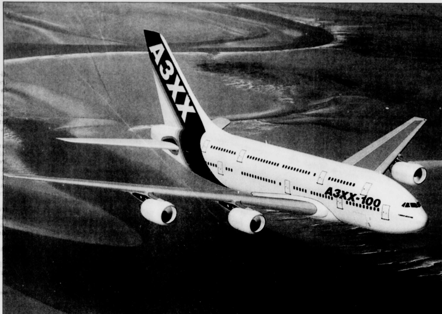
Une esquisse de l'Airbus A3XX qui offrira de la place à 555 passagers sur deux ponts.
