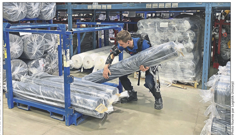
L'exosquelette réduit l'utilisation des muscles durant la manipulation des charges et oblige l'employé à bien forcer, puisque l'équipement l'empêche de faire un faux mouvement.
