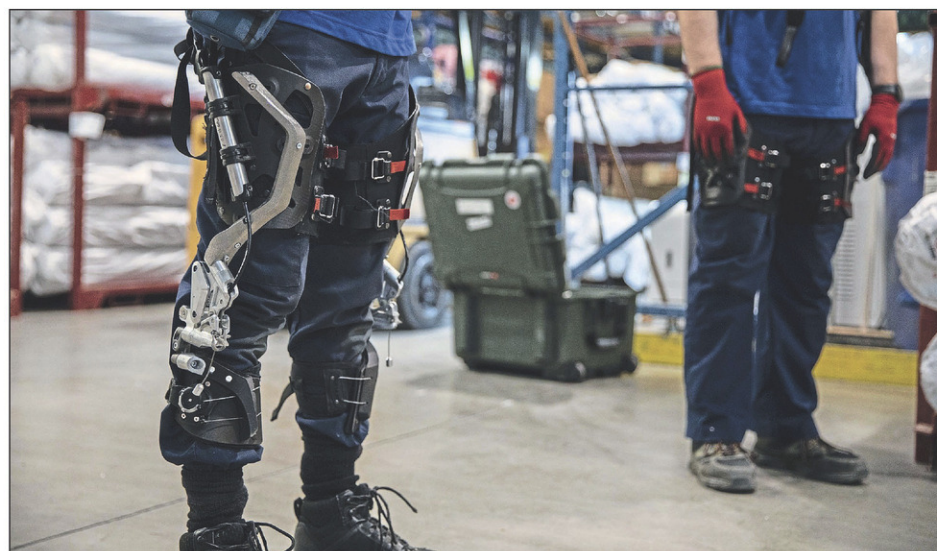
Selon les données fournies par Mawashi, l'exosquelette peut augmenter l'endurance des utilisateurs de 40% en permettant de réduire l'activation musculaire de 20% à 70%.
