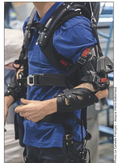
Un dispositif sur le bras permet d'activer l'exosquelette. Lorsqu'activé, l'équipement réduit l'utilisation des muscles durant la manipulation des charges. Et lorsqu'il est désactivé, le travailleur est libre de bouger comme il veut.
