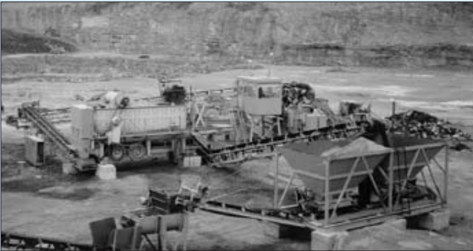
Usine de broyage de bardeaux d'asphalte.
