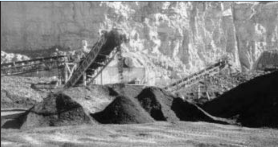
Mise en réserve des bardeaux d'asphalte.
