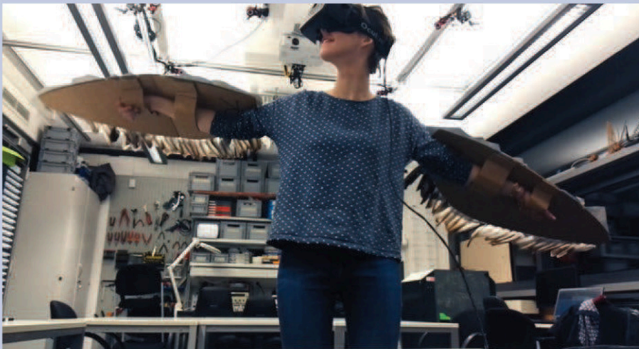
Une utilisatrice teste le prototype final de l'équipe de Gerold Hoelzl. Par leur forme et leur poids, les ailes donnent une rétroaction haptique. Leur position est suivie en temps réel pour contrôler l'avatar du jeu de réalité virtuelle. • IMAGES : GEROLD HOELZL, EISLAB
