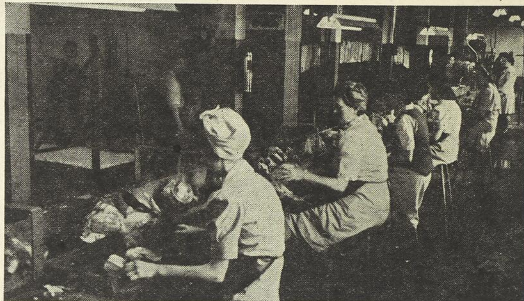
La première opération subie par les légumes en vue de leur déshydratation consiste à les nettoyer; à leur ôter les feuilles mortes et le trognon. Par-dessus la tête de la seconde ouvrière, remarquer un genre de pont; c'est le déshydrateur; le « tunnel ».
