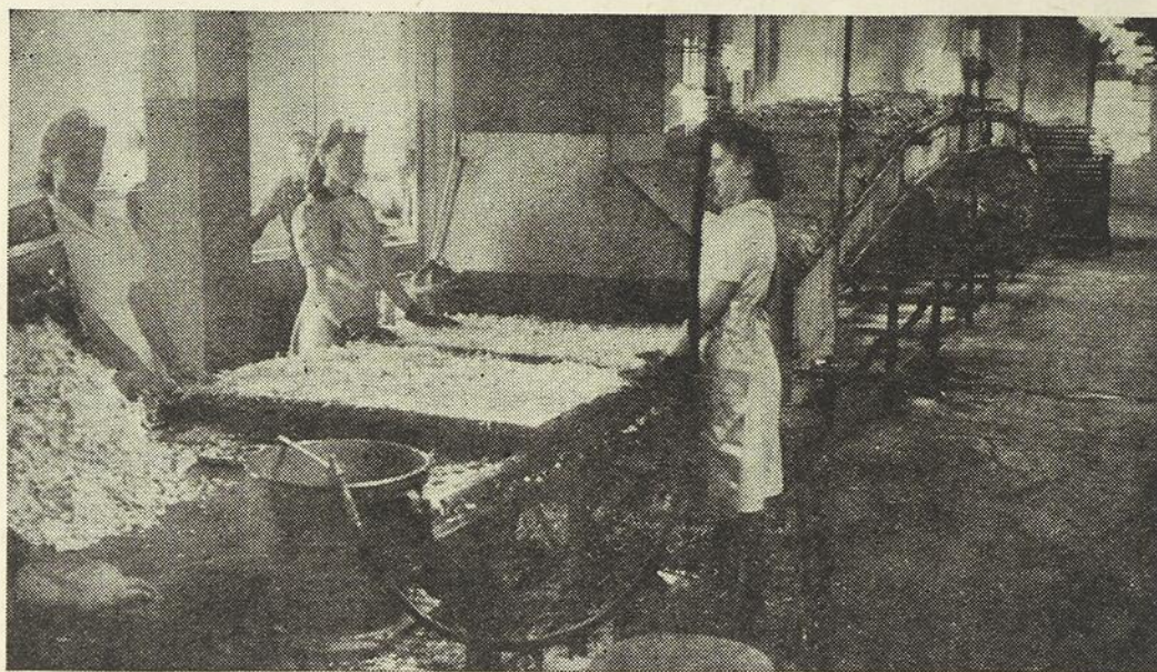
Voici le « tunnel », le déshydratateur dans lequel les légumes coupés en lamelles ou en petits cubes doivent passer pour être desséchés ou « déshydratés ».
