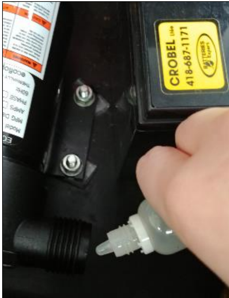
Figure 14. Préparation de la pompe avec l'ajout d'huile
