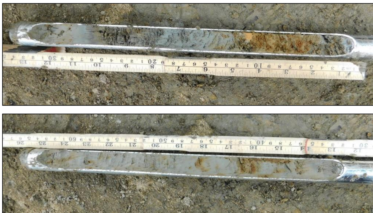
FIGURE 36. CAROTTES ISSUES DU SONDRAGE À LA TARIÈRE MANUELLE (1 PO) MONTRANT LA POURSUITE DE L'ARGILE BLEUE CeEt-989-1A9 (25LAHP04-084 ET 25LAHP04-085).
