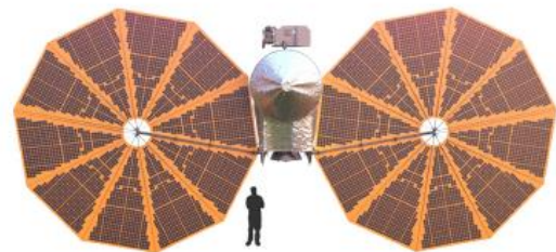
La sonde Lucy est dotée de deux immenses panneaux solaires circulaires.
