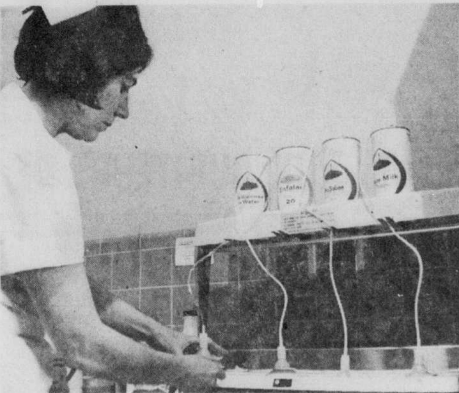
LE REMPLISSAGE ASEPTIQUE des biberons s'effectue au moyen de dispositifs de transvasement stériles à jeter après usage. L'appareillage comprend les boîtes de formules préparées, avec tube communiquant au biberon en vase clos. Le remplissage se fait selon le principe des vases communicants.
