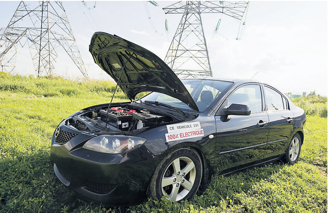
PHOTO HAI AU BUI, FOURNIE PAR VOITURES ÉLECTRIQUES DU QUÉBEC Les véhicules convertis par la PME Voitures électriques du Québec devraient coûter entre 22 000 et 27 000 dollars. Ils auront une autonomie de 100 km et pourront être branchés sur des prises ordinaires pour être rechargés.
