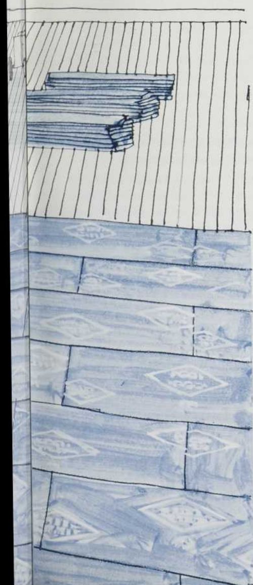
Le feutre est passé sur une feuille de base enduite à l'usine. L'asphalte chaud ne vient pas en contact avec le Roofmate FR.
