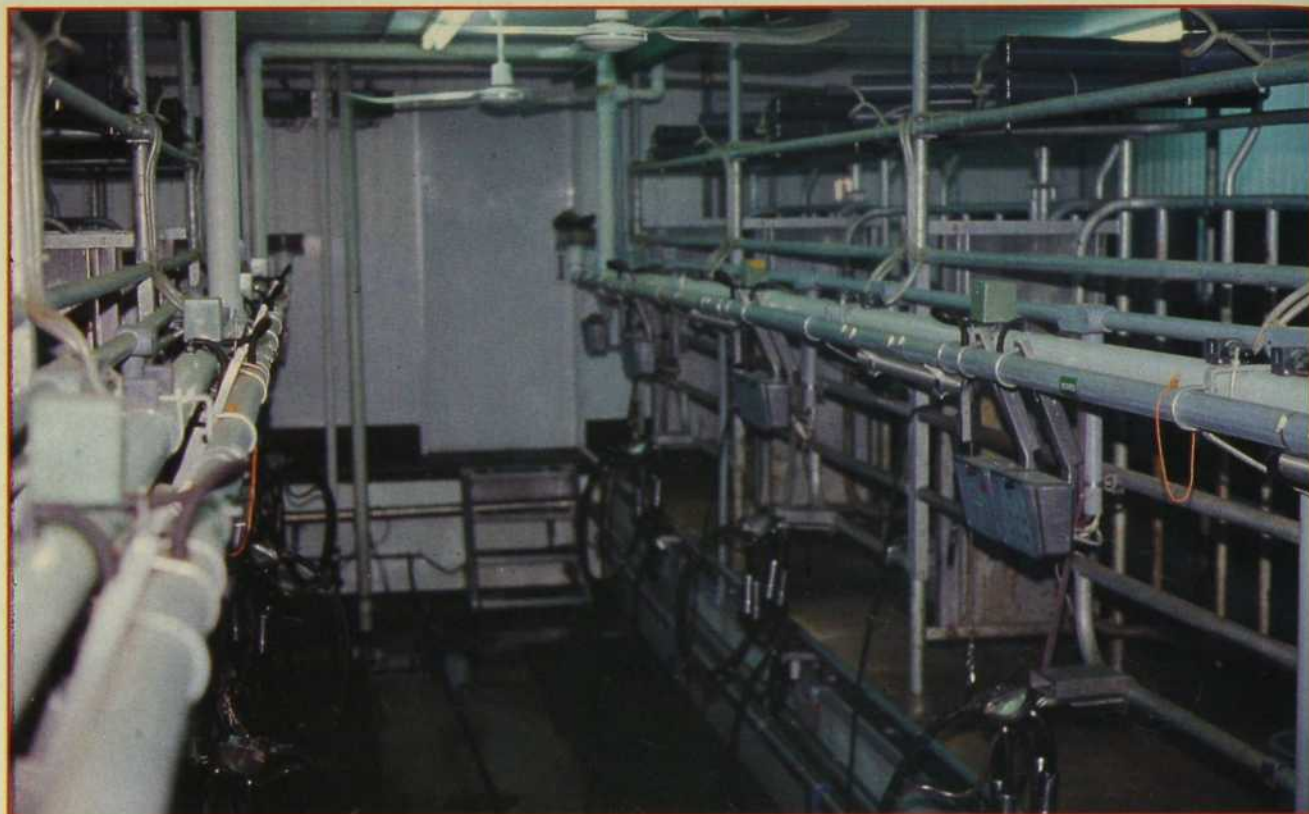
Un dispositif de stimulation équipe les trayeuses des huit postes de traite.
