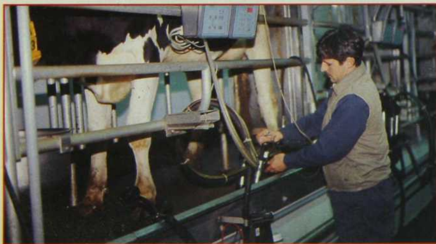
Un collier électronique identifiant chaque vache enregistre sa récolte de lait et son comportement journalier.
