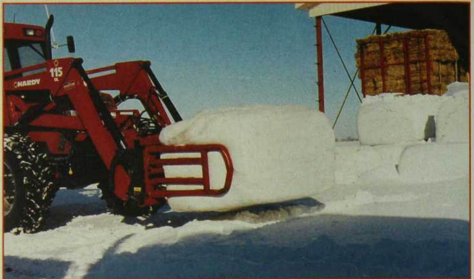
Les grosses balles de foin vert sont transportées avec des pinces spéciales qui n'endommagent pas l'enrobage.
