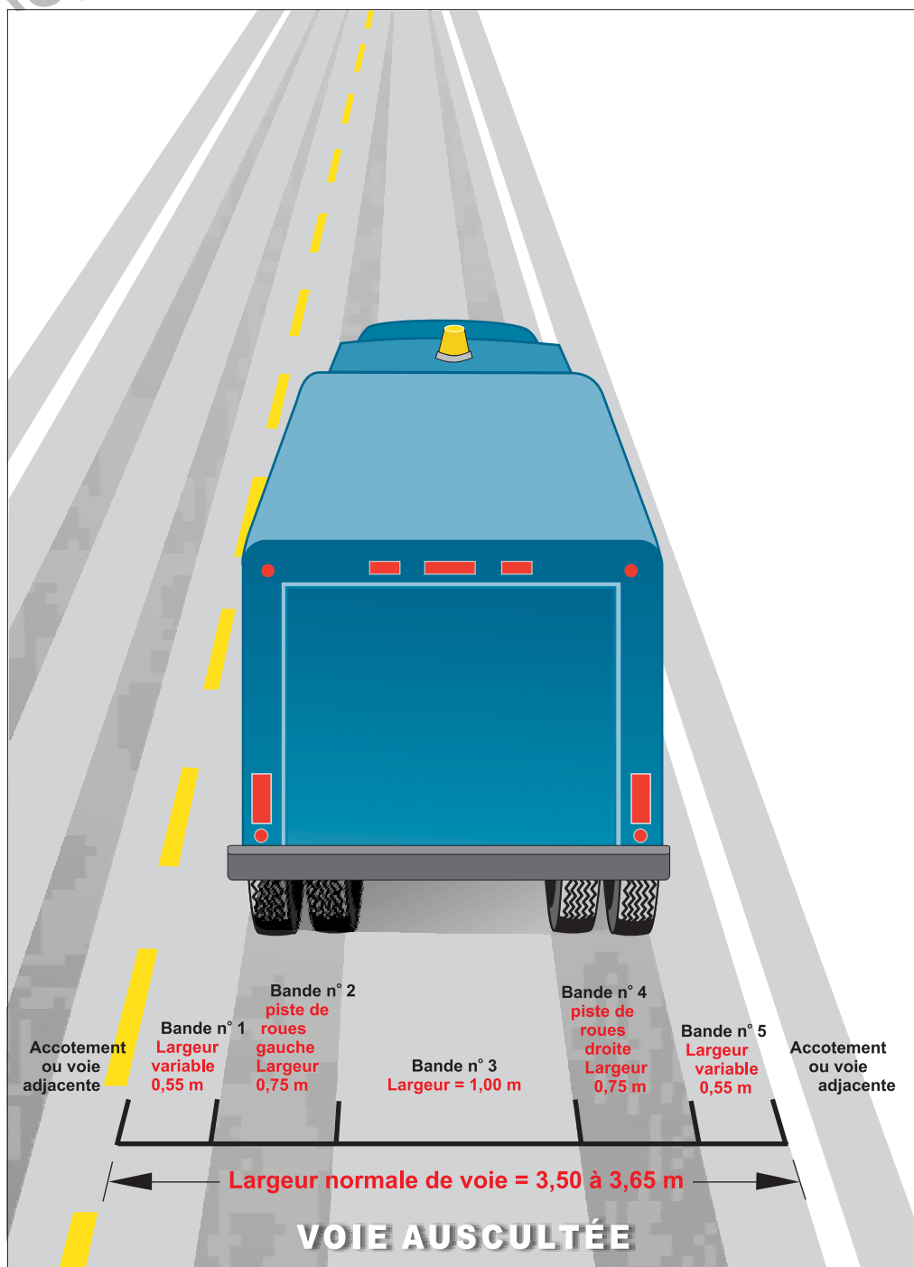
Figure 1-1 Détails des bandes d'auscultation pour la fissuration
