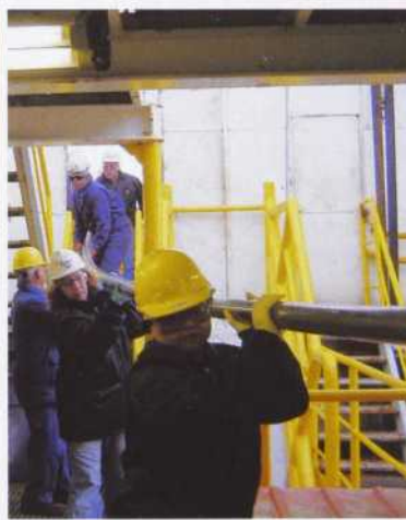
Récupération d'une carotte (9,5 mètres de long) lorsqu'elle arrive sur le pont.
