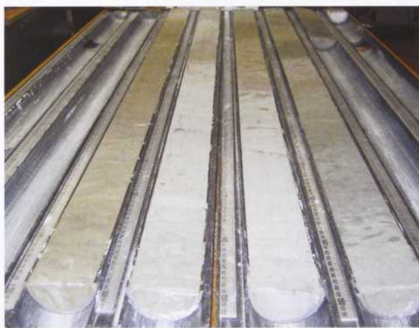
Tronçons de carottes représentant une accumulation sédimentaire de près d'une centaine de milliers d'années. Les boues claires qui évoquent une sédimentation biogénique carbonatée correspondent à un épisode chaud interglaciaire.
