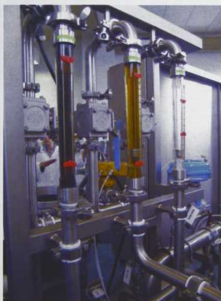
Procédé d'ultrafiltration membranaire permettant le fractionnement des biomolécules marines, dont les protéines et peptides, selon leur taille moléculaire.
