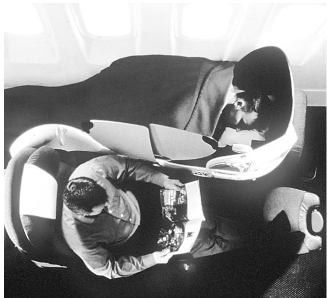
British Airways installe en classe affaires des fauteuils-lits, une première. Les blocs de deux sièges, disposés tête-bêche, se transforment en couchettes grâce à des repose-pieds ajustables.
