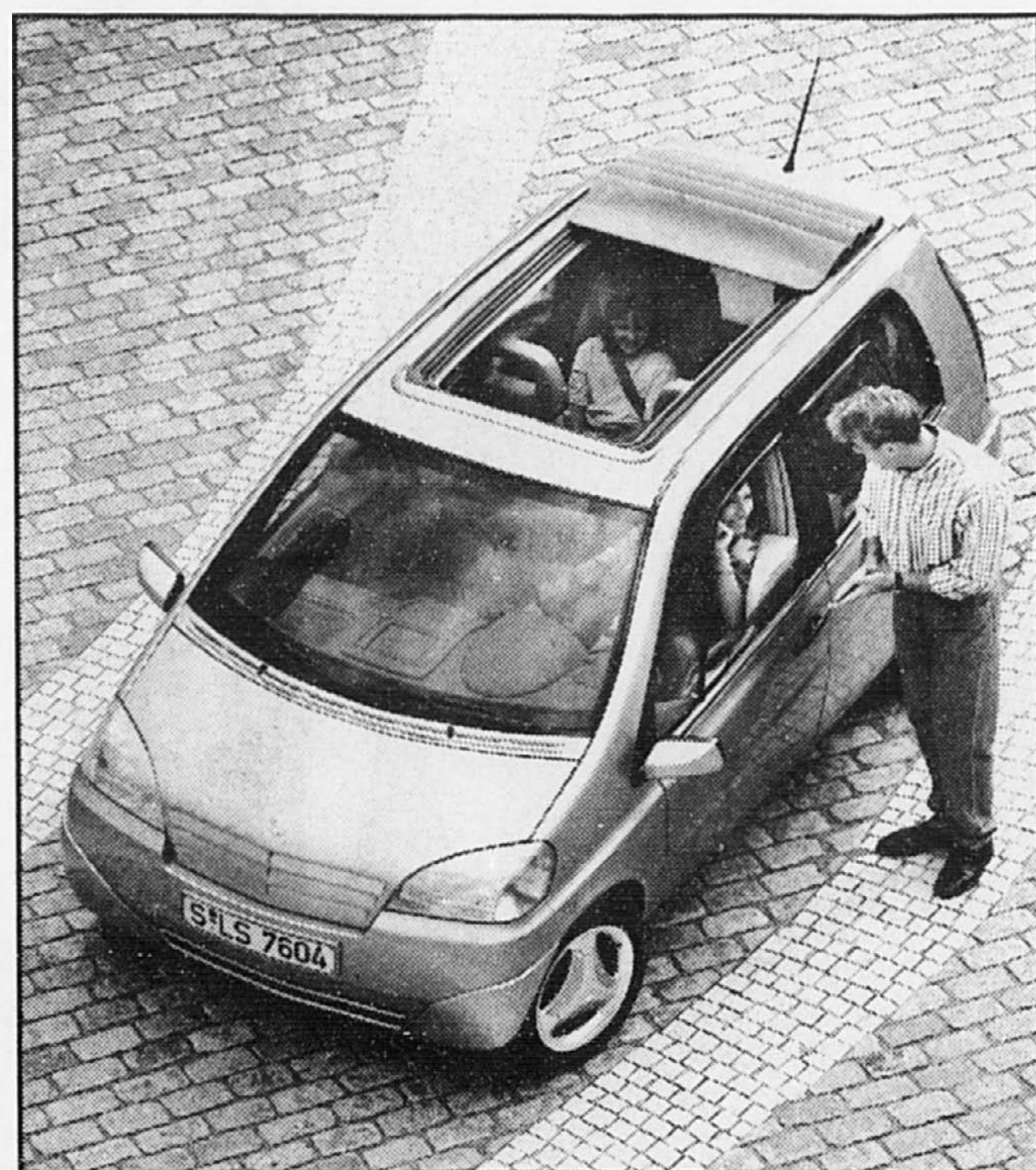
La Vision A de Mercedes est une voiture de très petites dimensions mais assurant la même habitabilité qu'une voiture compacte.
