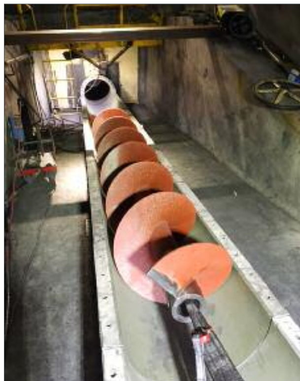
La vis du silo, élément crucial aux opérations
