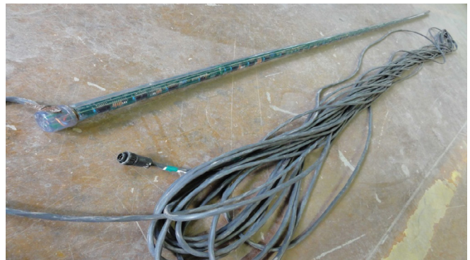
Figure 3 : Sonde électronique de profondeur de gel
