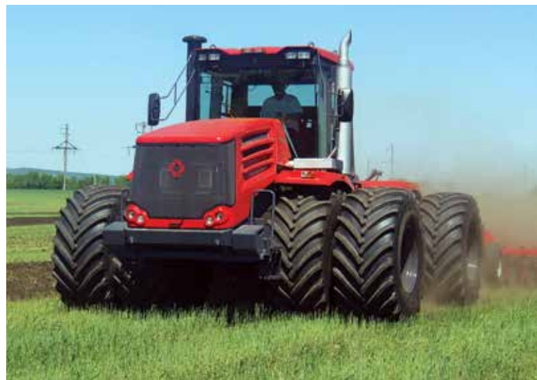
Le Kirovets K744 de MTZ est le seul tracteur à quatre roues motrices de grande puissance au Canada dont le moteur n'est pas géré par ordinateur.
