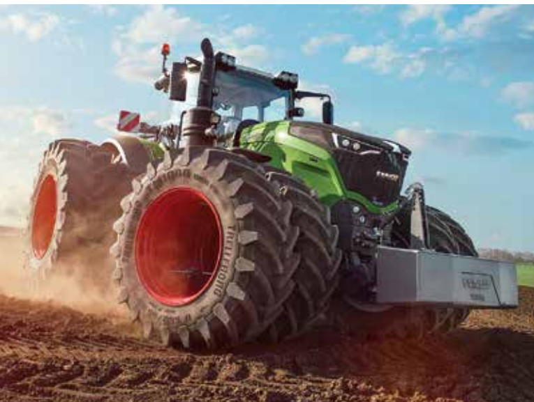
Les tracteurs Fendt de grande puissance sont offerts avec une nouvelle version du système de gonflement-dégonflement des pneus.
