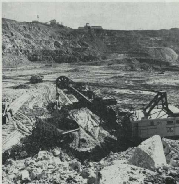
Fig. 8. La mine à ciel ouvert Jeffrey, à Asbestos, dans la province de Québec, est la plus grande mine d'amiante du Canada, chef de file des producteurs d'amiante du monde. Des camions d'une capacité de 35 tonnes sont ici chargés à l'aide de pelles mécaniques électriques. Toutes les mines d'amiante canadiennes sont maintenant à ciel ouvert.
