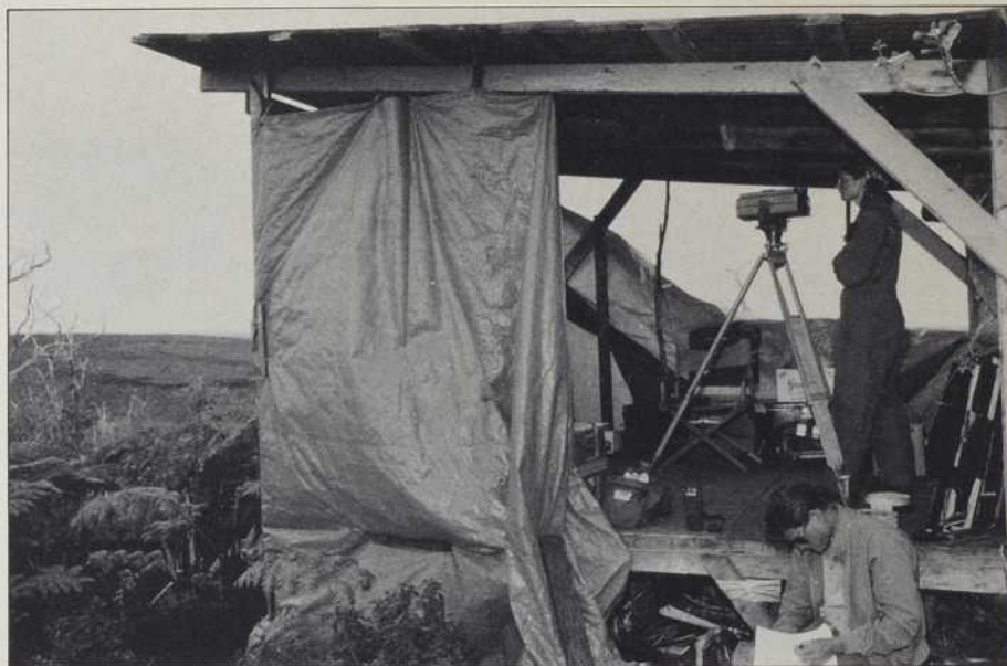
Installée au camp d'observation du Pu'u O'o, Christina Heliker mesure les déformations du sol à l'aide d'un appareil au laser.
