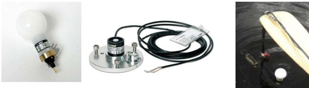
Figure 4 : Quantimètre, avec capteur pour mesurer dans l'air et capteur pour mesurer la lumière transmise dans l'eau
