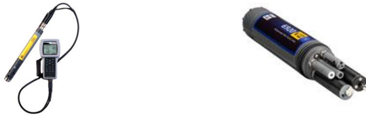
Figure 3 : Deux modèles de multisondes pour les mesures de température, d'oxygène et du pH dans l'eau de rivières ou à la surface du lac (YSI600E) et pour des profils dans le lac (YSI6920)
