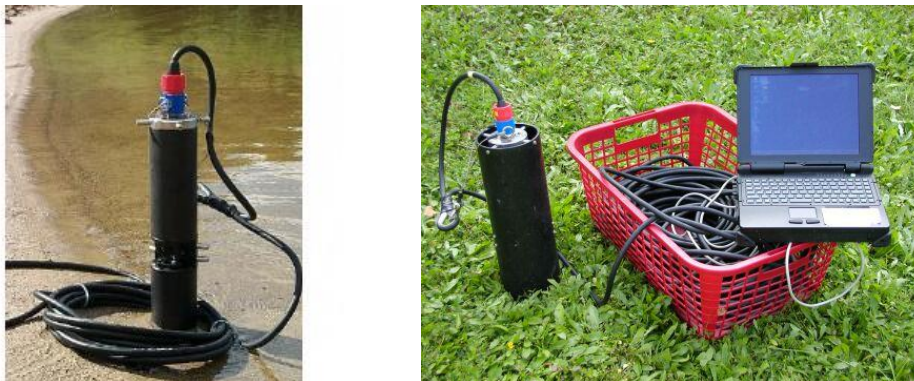
Figure 7 : Sonde fluoroprobe pour identifier et quantifier les grands groupes d'algues
