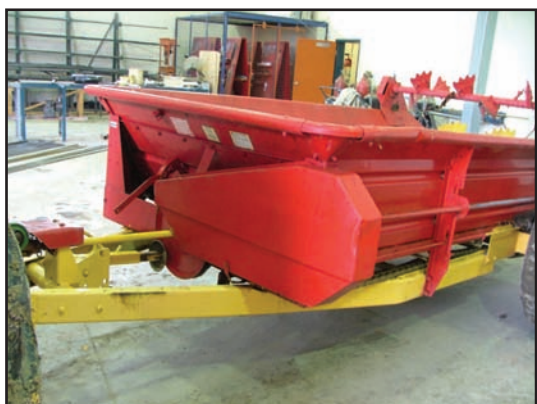
Protecteur fixe des poulies et des courroies
