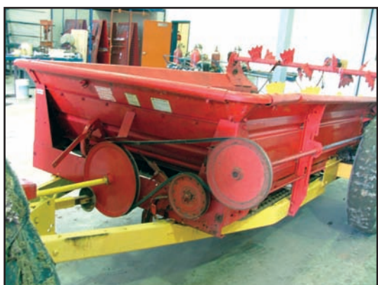
Poulies et courroies non protégées
