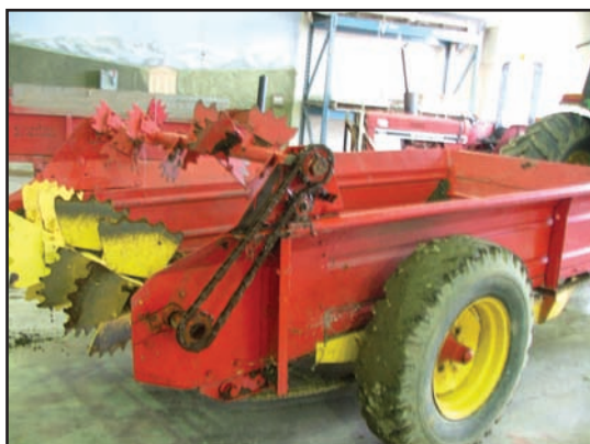
Chaîne et engrenages non protégés
