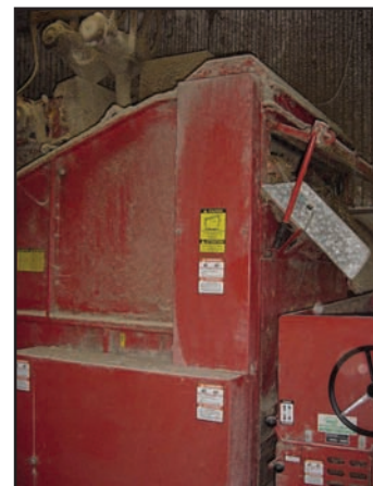
Protecteur fixe installé
