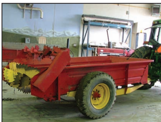
Protecteur fixe de la chaîne et de l'engrenage
