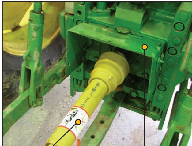
Arbre de transmission et prise de force protégés
