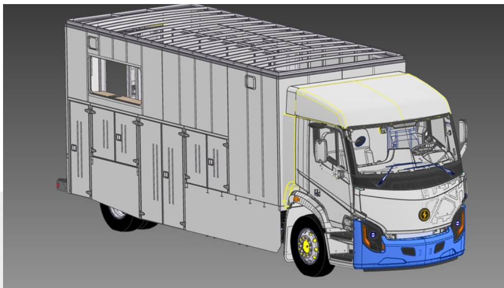
Figure 1 : Véhicule-atelier avec accessoires aérodynamiques
