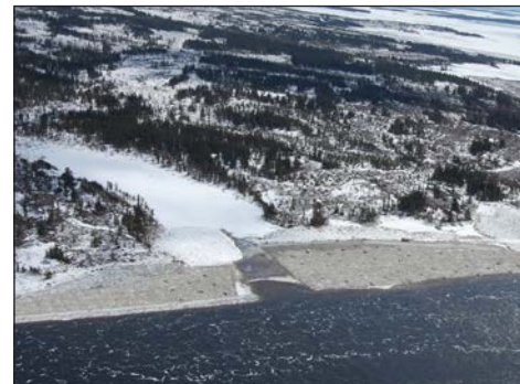
Frayère multispécifique aménagée dans le canal de fuite de la centrale de la Sarcelle
