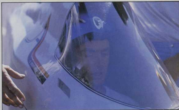
△ Des coéquipiers assurent la stabilité de ce véhicule à deux roues. À cause d'un carénage complet sous le véhicule, le pilote ne peut poser ses pieds à terre pour maintenir son équilibre.
