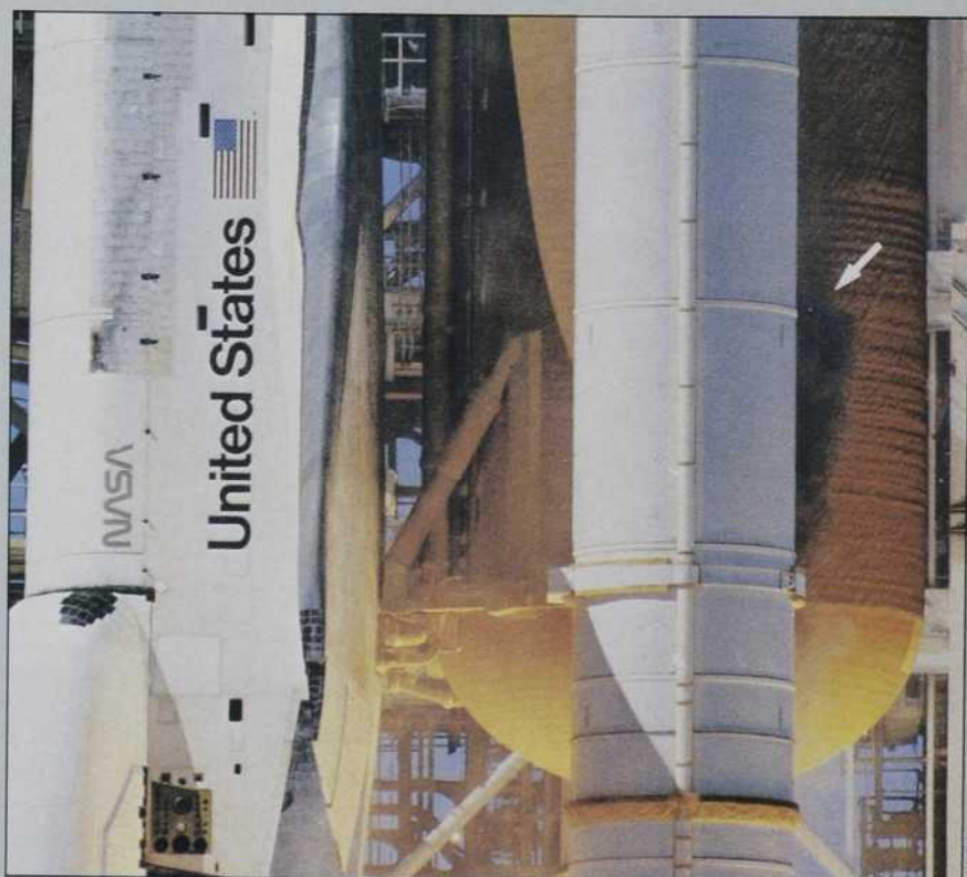
L'analyse des photographies permet de déterminer que 0,678 seconde après la mise à feu des fusées d'appoint, on pouvait discerner de la fumée au niveau d'un joint sur la fusée d'appoint droite.
