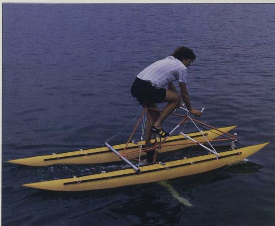
Le Flying Fish se situe parmi les véhicules les plus rapides sur l'eau. Lorsque le cycliste atteint une certaine vitesse, les flotteurs ne touchent plus l'eau. La partie blanche, sous l'eau, sert d'ailes sous-marines. Une hélice, située à l'arrière, propulse l'engin.
