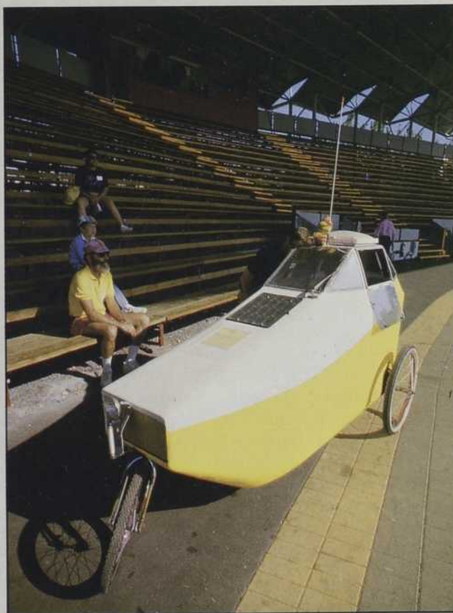
◁ Les concepteurs de Pod l'ont équipé de lumières fluorescentes, d'une machine à écrire électronique et... de piles à énergie solaire!
