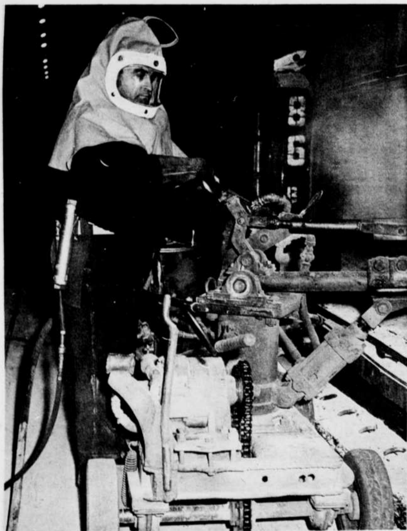
L'EMPLOYE PORTE ICI LA CAGOULE et le costume ventilé au complet. Cet équipement lui permet de respirer un air sain et refroidi, même lorsqu'il travaille à casser la croûte dans la cuve d'électrolyse.
