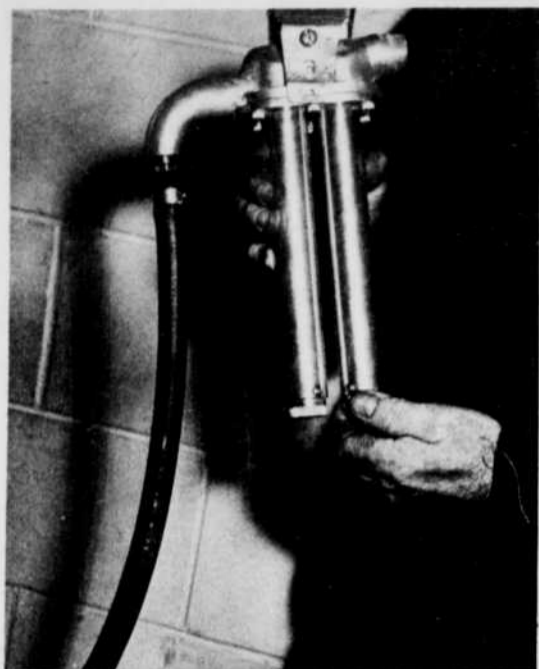
C'EST DANS CE TUBE DOUBLE, on l'appelle TOURBILLON, qu'un inventeur et véritable magicien a réussi le tour de force de refroidir l'air à un degré respirable. Le résultat est pour ainsi dire instantané, mais combien d'années de recherches a-t-il fallu pour en arriver là?
