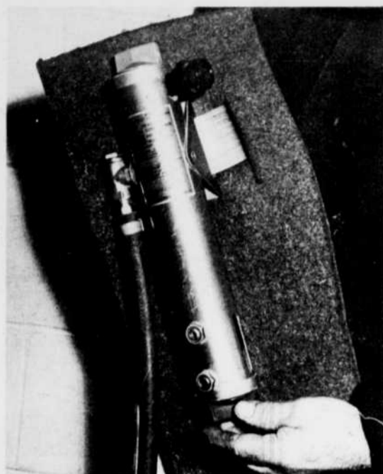
VOICI UN AUTRE MODELE de tube qui peut remplir deux fonctions: ou bien refroidir l'air, ou bien le réchauffer.
