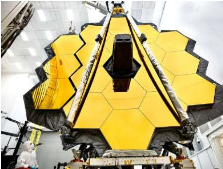
Le miroir principal du télescope Webb, composé de 18 segments hexagonaux. À droite, le miroir replié en prévision de son lancement à bord d'une fusée Ariane.
