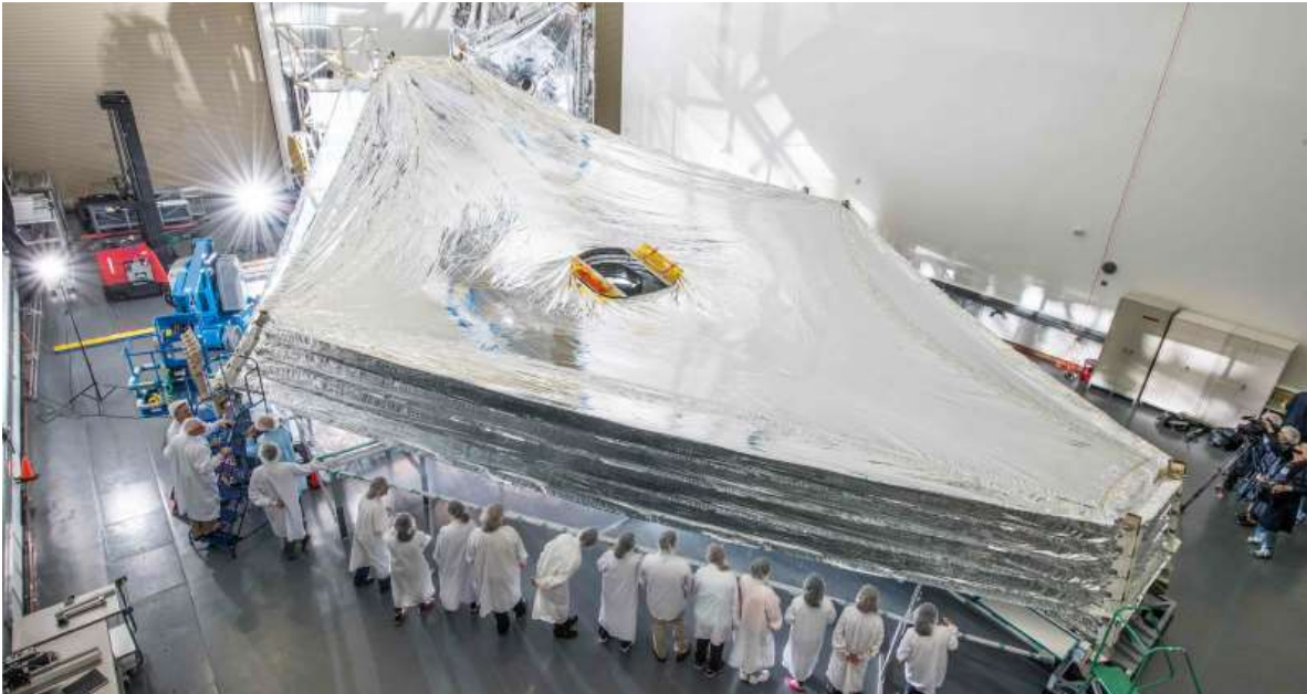
L'écran solaire, en cinq épaisseurs, qui protégera le télescope des trois principales sources de radiations infrarouges: le Soleil, la Terre et la Lune. Remarquez les personnes qui se tiennent au bas de la toile et qui donnent l'idée de sa taille.
