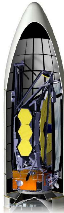
Le miroir principal du télescope Webb, composé de 18 segments hexagonaux. À droite, le miroir replié en prévision de son lancement à bord d'une fusée Ariane.
