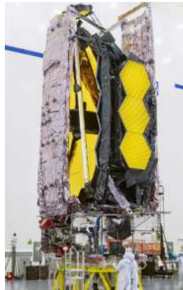
Le miroir principal du télescope Webb, composé de 18 segments hexagonaux. À droite, le miroir replié en prévision de son lancement à bord d'une fusée Ariane.
