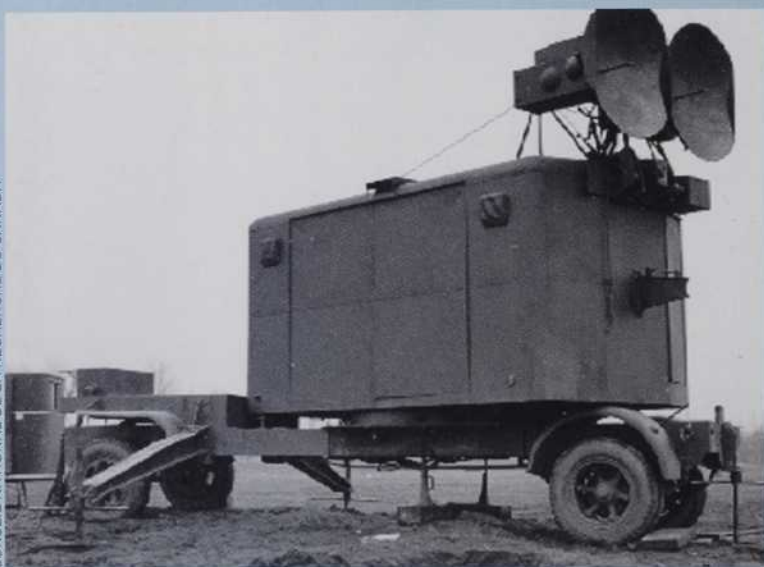
Radar de type GL Mark III C À l'été 1943, les militaires installent secrètement un réseau de stations radar entre Matane et Cap-Gaspé afin de repérer les U-Boot qui s'aventurent dans le fleuve Saint-Laurent. Cette mesure de protection pouvait laisser à désirer pour l'époque, mais elle démontre le sérieux des autorités canadiennes suite aux torpillages de l'année 1942.
