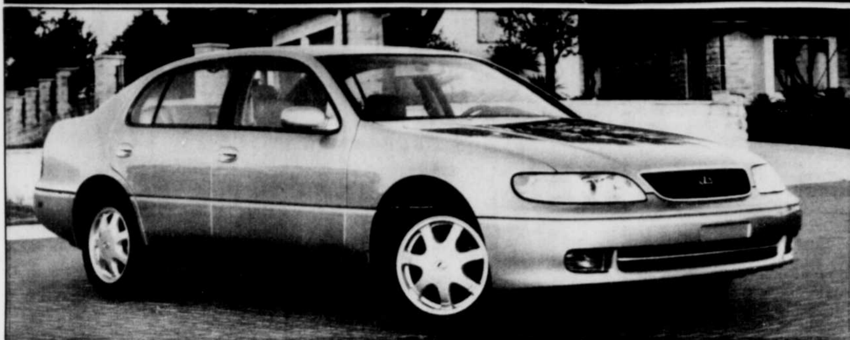
La GS 300 se démarque par sa ligne dynamique et moderne. Son coefficient de traînée aérodynamique (Cx) est de 0,31.
