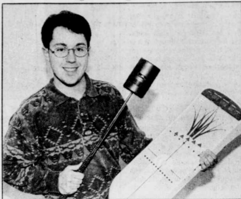
François Taddei, du Club DOS (photo du haut) montre les principaux éléments du « Pro Swing », la plaque abritant les capteurs et le bâton, construit expressément plus court qu'un vrai bâton de golf pour pouvoir être utilisé dans une pièce de hauteur normale. À droite, le distributeur du nouveau simulateur, Michel Décarie, donne une démonstration de son savoir-faire.
