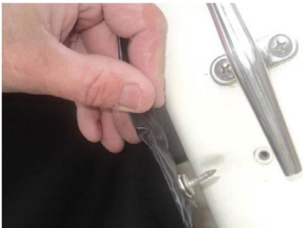
Une vis qui ne tient plus qui avait été fixée avec du silicone.
