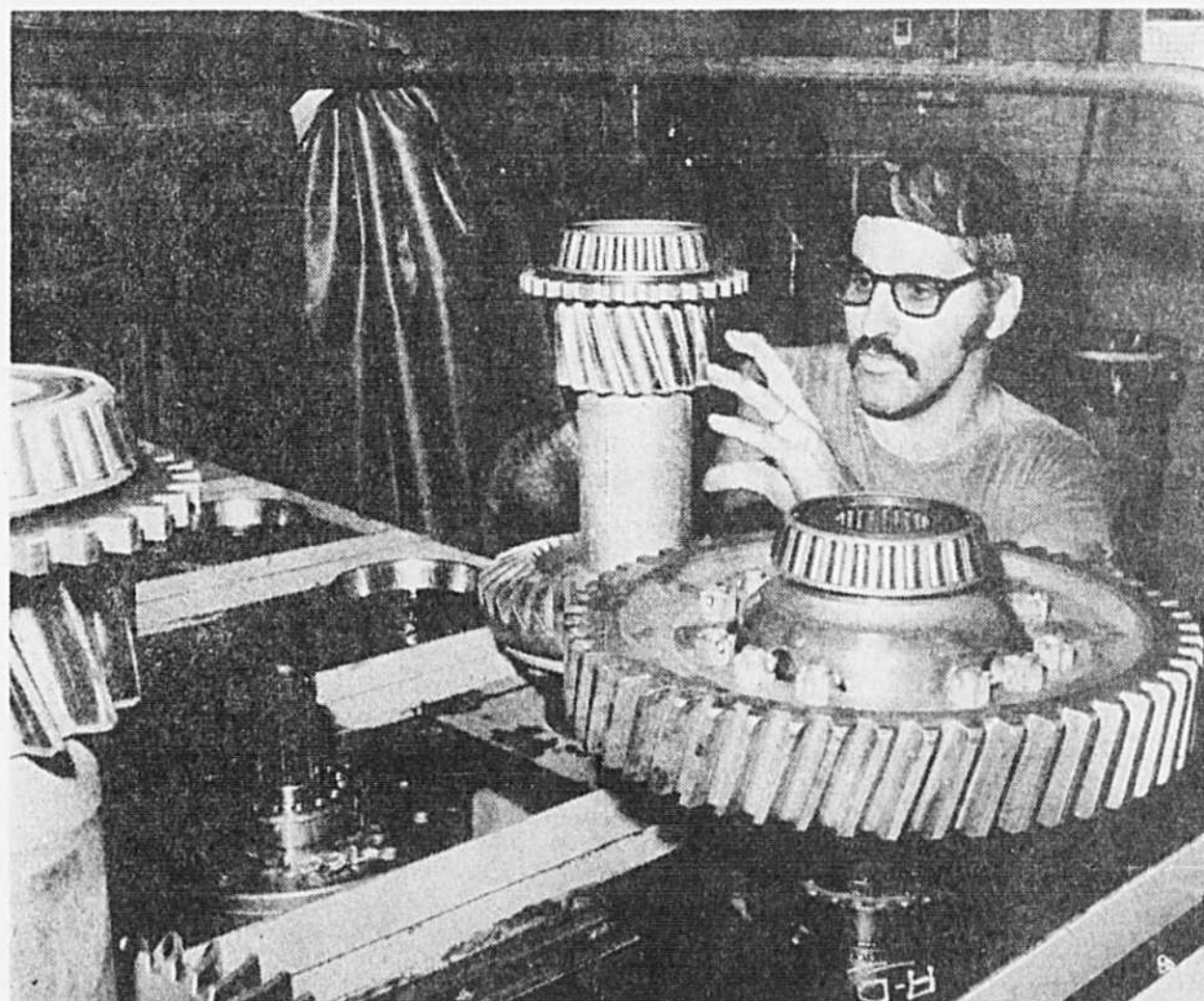
Un mécanicien du service d'entretien des véhicules du métro, M. Pierre Sigouin, au milieu de différentiels en pièces détachées: il nomme chacune d'elles avec une aisance déconcertante. "Le pignon d'attaque qui forme avec la couronne le couple spiroconique, l'arbre intermédiaire, le couple droit, etc."
