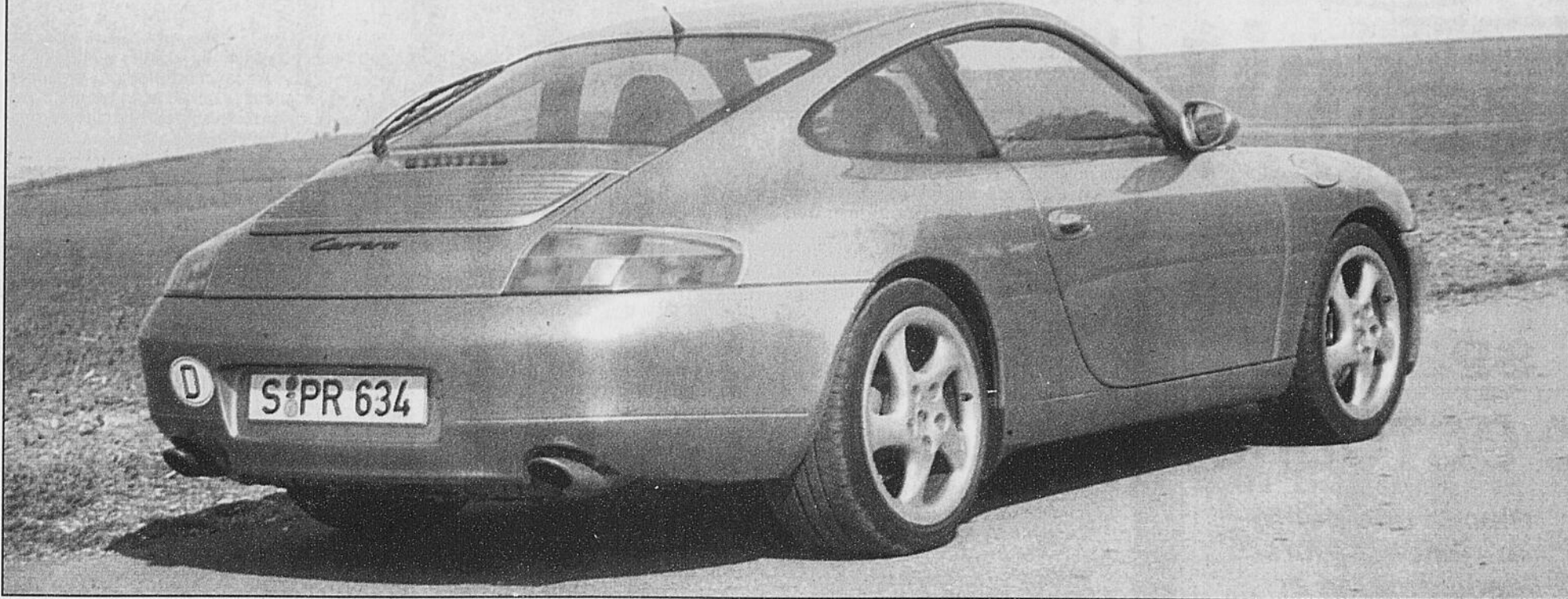
Dans cette 911 plus spacieuse et plus aérodynamique, le moteur reste implanté à l'arrière mais est désormais refroidi par eau plutôt que par air.
