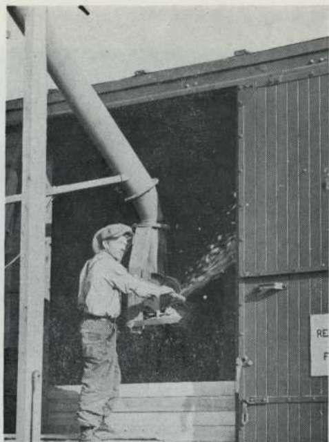
Fig. 26 — Soufflerie pivotante pour le chargement de wagons de fret.
