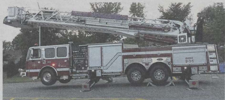
Le camion est muni de quatre pattes offrant une meilleure stabilité dans les rues en pente ou sur des terrains accidentés. (Photo Gracieuseté - Ville de Saint-Georges)
