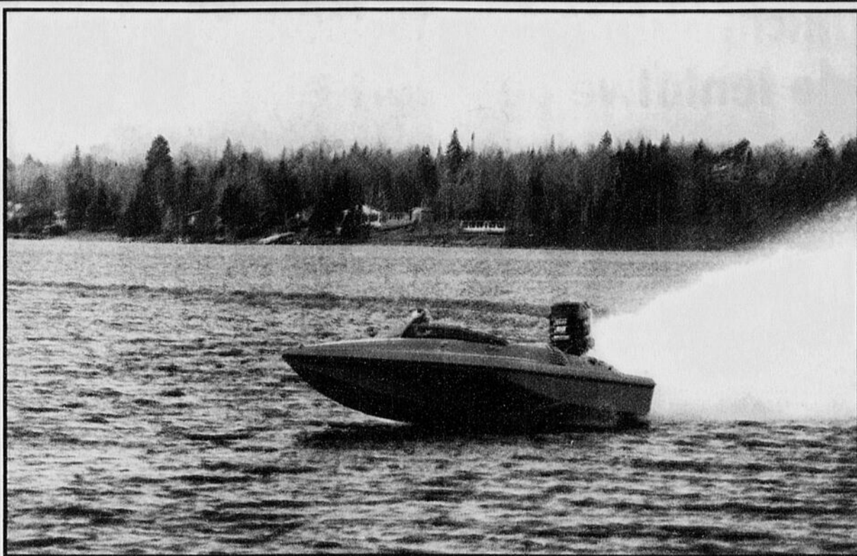
Photo La Tribune, par Gilles Besmargian L'aspect extérieur du bateau est plutôt conventionnel. Le secret de sa grande vitesse réside dans la forme de la coque qui s'allie à la puissance du groupe propulseur, pour transformer l'embarcation en un véritable bolide.
