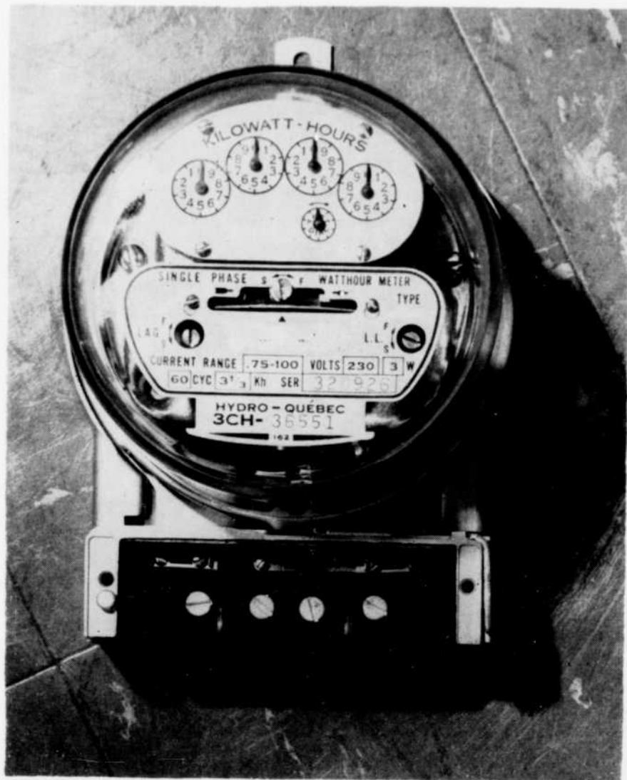
Fig. 1 — Un wattheuremètre moderne
