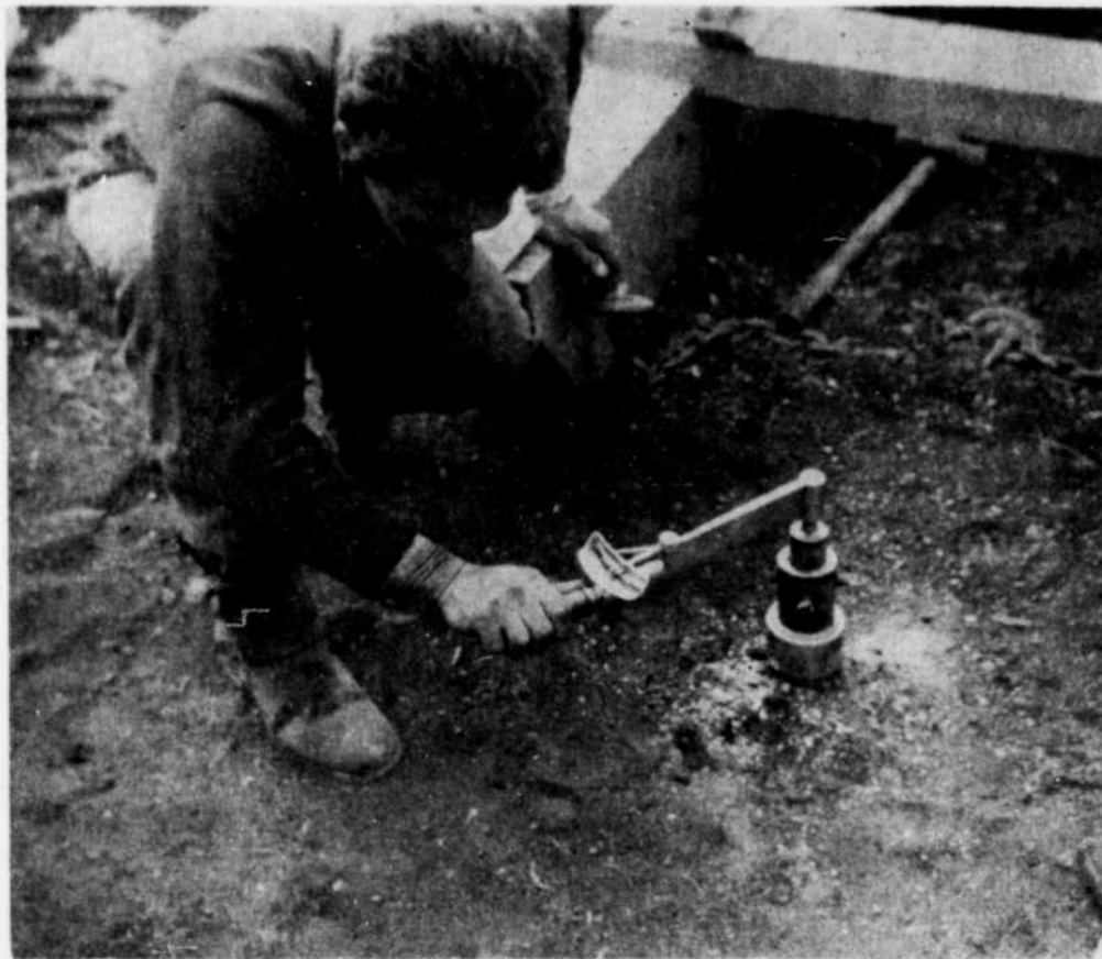
Essai au cissomètre sur un dépôt d'argile près de Saint-Janvier Auto-route Montréal-Laurentides
