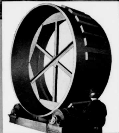
"ROUE" DE FOUR À CIMENT
