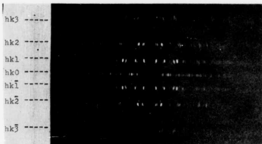
Fig. 9 — Une photo de rotation. Exposition aux rayons X produits par un tube à cathode de cuivre. Radiation non filtrée. Rotation d'un spécimen de natrolite autour de son axe "C".
