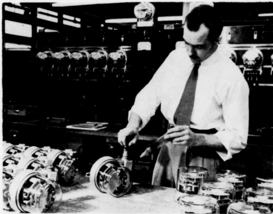
Fig. 6 — Scellage par cachet de cire fondue. Laboratoire de l'Inspection Fédérale au Centre de Service de l'Hydro-Québec
