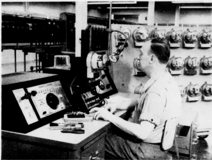
Fig. 8 — Vérification et étalonnage par stroboscope : tableau à position unique
