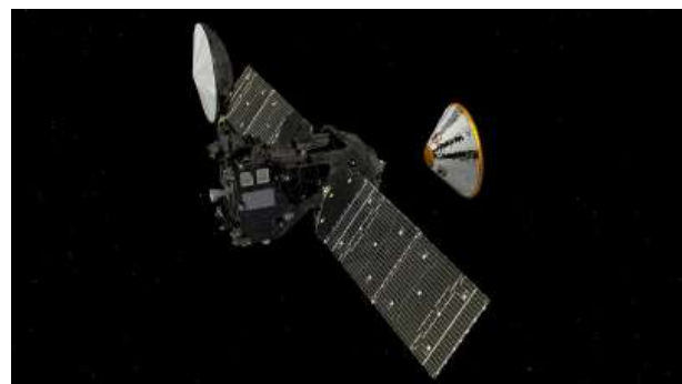
La séquence d'atterrissage débute lorsque l'orbiteur ExoMars TGO largue la capsule contenant l'atterrisseur Schiaparelli (à droite).
